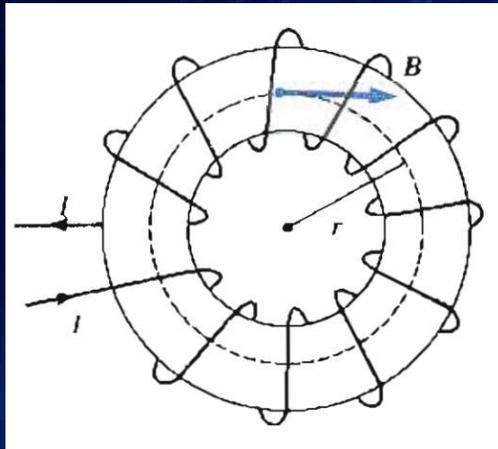
Una bobina toroidal consta de  $N$  vueltas de alambre alrededor de una estructura en forma de aro. Suponiendo que las vueltas están estrechamente espaciadas, calcúlese el campo magnético en el interior de la bobina, a una distancia  $r$  de su centro.
