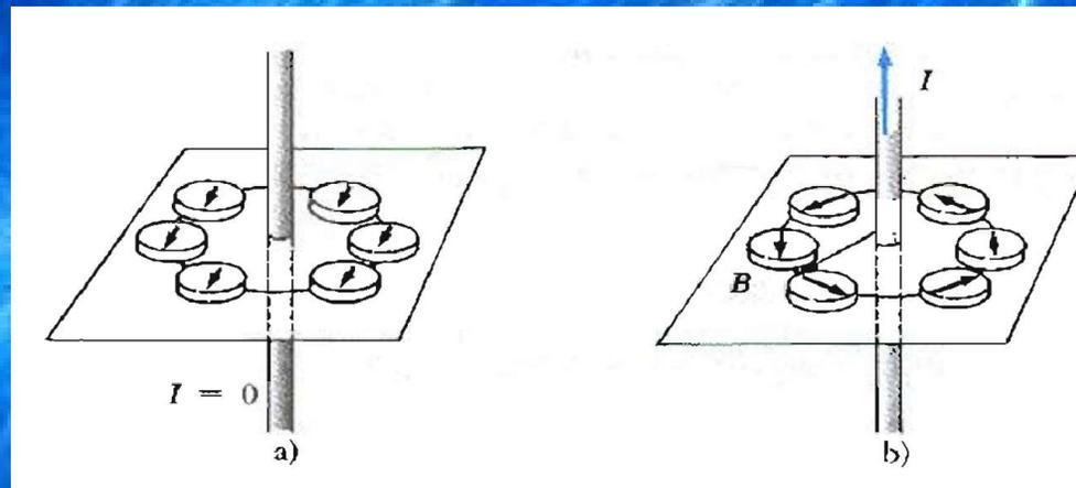
Por simetría, la magnitud de  $B$  es la misma en cualquier lugar sobre una trayectoria circular que está centrada en el alambre y que se encuentra en un plano perpendicular al alambre. Si se varía la corriente y la distancia al alambre, se encuentra que  $B$  es proporcional a la corriente e inversamente proporcional a la distancia al alambre.
