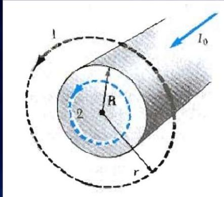
Un alambre largo recto de radio  $R$  lleva una corriente estable  $I_0$  que está uniformemente distribuida a través de la sección transversal del alambre.
